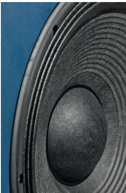
Membrana 15-calowego głośnika niskotonowego JBL-a niemal nie zmienia się na przestrzeni lat, a nawet wieków... Klasyczna, dobra celuloza i charakterystyczne koncentryczne przetłoczenia, poprawiające przetwarzanie średnich częstotliwości.
